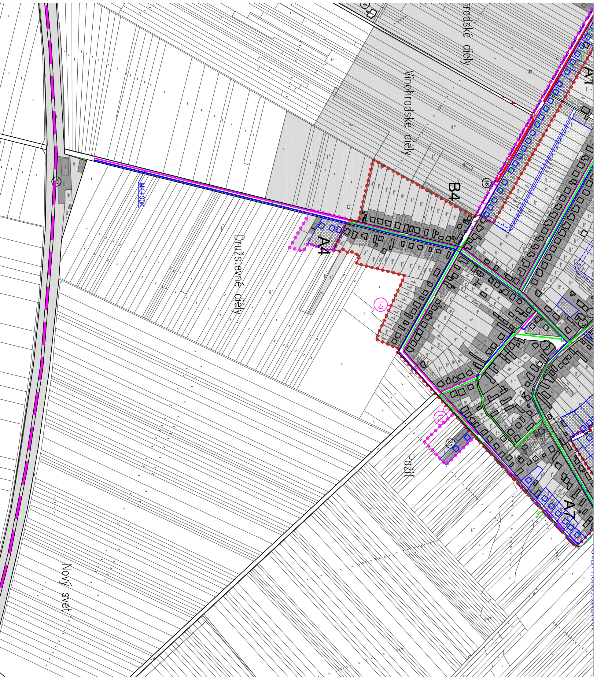
VÝKRES RIEŠENIA VEREJNEJ TECHNICKÉJ VYBAVENOSTI, zásobovanie energiou a plynom - súčasný stav, rok 2008 1:5000
